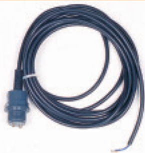
Sonda di Conducibilità (corpo in PVC o PTFE) con due elettrodi AISI 316, costante di cella K=1 (0÷20.000 µS), K5 (0÷2.000 µS), per strumento E.CO.CD. Su richiesta compensazione della temperatura.
